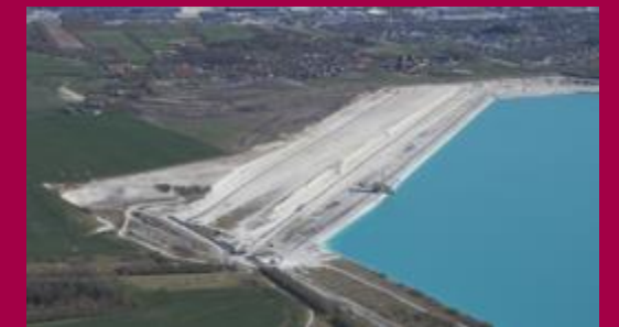
Rørdal Kridtgrav. Man kan se de tre fronter der graves på. Topgravefront, mellemgravefront og dybdegravefront. Foto: Region Nordjylland
